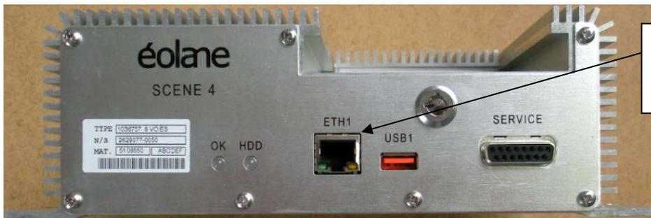
Entrées réservées aux raccords des caméras IP
