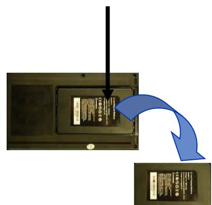
Pour remplacer la batterie, répéter les étapes de la procédure ci-dessus en sens inverse.
