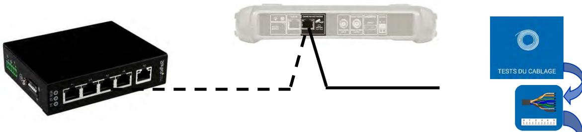
Test câble RJ45 avec TDR
