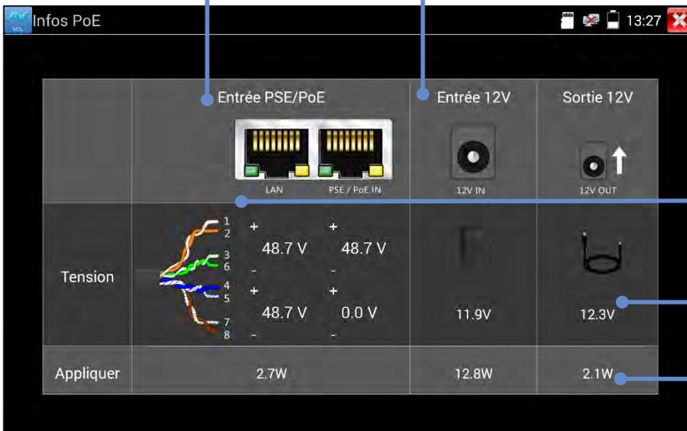
Indique les N° des fils concernés sur l'entrée PoE IN. La tension PoE provenant d'un actif PSE, injecteur ou switch PSE passera par le port RJ45 vers le port de sortie " Camera/Network" mais pas les données
