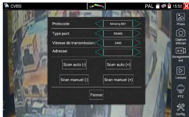
Paramétrez le protocole, le port de communication, la vitesse de communication, pour pouvoir correspondre à la caméra PTZ testée, puis appuyer sur "Scanner" et enfin lancer la recherche de l'adresse de la caméra PTZ.
