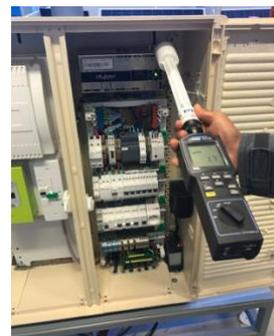
4.1.3.B A l'extérieur de l'armoire (environs 20 cm) porte fermée en direction de l'antenne du citybox contrôleur.
