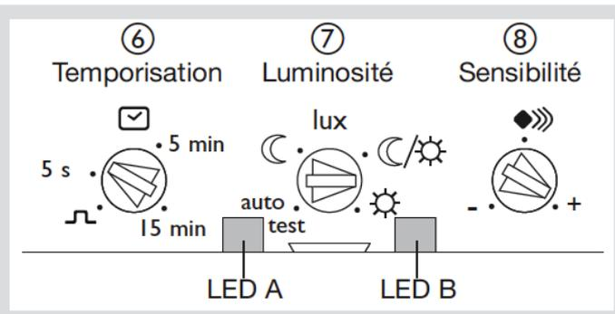
Réaliser l'auto test de chaque détecteur de présence en appliquant la procédure définie par la documentation technique.
