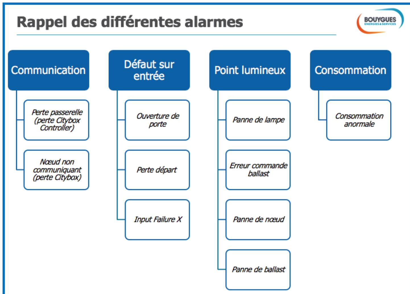
La plupart des alarmes ne signifient pas que le système est défaillant, ou que la lampe n'éclaire plus, mais préconisent le remplacement d'un élément vieillissant ou doivent faire l'objet d'une visite de contrôle.
