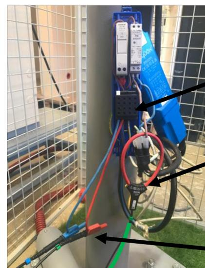
Raccordement de cordons double puits sur le bornier de raccordement des circuits électriques du Mat N°1.
