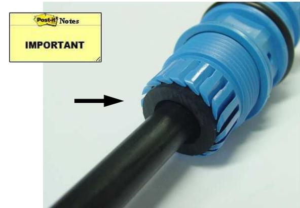
*Serrer en butée l'écrou de presse étoupe contre le corps de presse étoupe. Si le serrage n'est pas possible manuellement utiliser une clé plate de 27mm pour maintenir le corps de presse étoupe*
