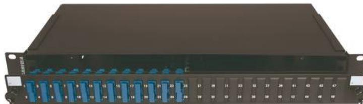
Tiroir optique coulissant pré-équipé de 24 raccords SC/APC simplex permettant le brassage jusqu'à 48 fibres monomode.
