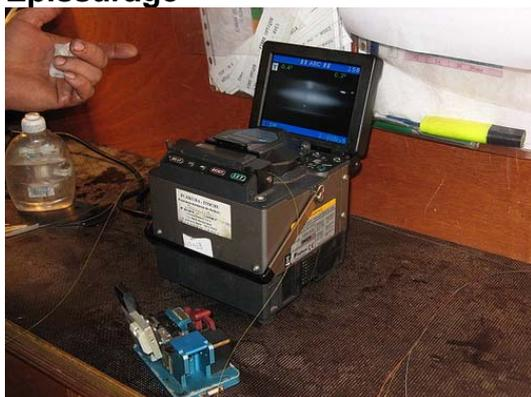
L'épissurage est le fait de raccorder deux fibres optiques. Pour ce faire il faut les positionner l'une en face de l'autre de manière minutieuse, généralement cet étape est assistée d'appareil pré calibrés. Ensuite on les bloque dans cette position à l'aide un boîtier plastique ou d'une fusion optique. Ensuite vient le test d'épissurage pour vérifier la qualité de transmission de la fibre.
