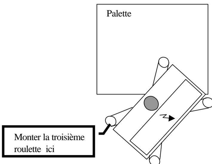
Croquis N°5 (borne vue du dessus) : mettre en place une cale sous le pied de la machine (h=120 mm) retirer la palette, attention de ne pas faire basculer la borne et monter la quatrième roulette :
