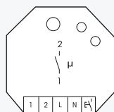
**1 Contact NO, libre de potentiel 10 A /250 V AC, lampes à incandescence 2000 Watt, retardement au déclenchement avec avis d'extinction et avec éclairage permanent par bouton-poussoir. Compatible avec le cryptage, communication radio bidirectionnelle et fonction répétiteur peuvent être enclenchés. Perte en attente seulement 0,8 Watt.**
